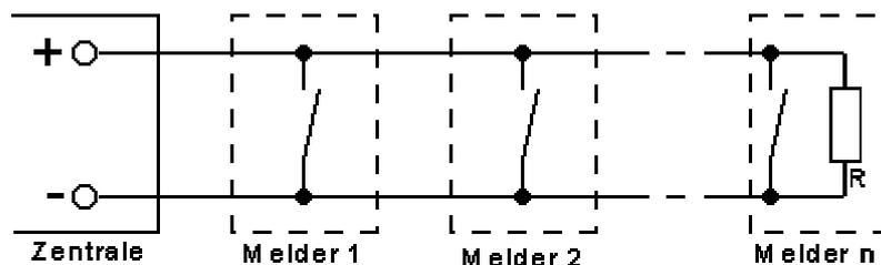
Bei dem Stromverstärkungsprinzip wird beim Auslösen eines Melders, der Abschlußwiderstand  $R$  im letzten Melder überbrückt und so der Stromfluß in der Linie erhöht.
