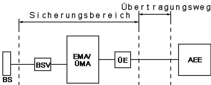
Das Blockschloß wird über einen Blockschloßverteiler an die ÜMA/EMA angebunden. Es befindet sich jedoch außerhalb des gesicherten Bereichs.
