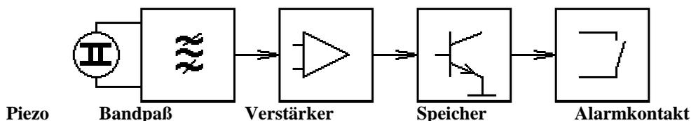
Findet ein Glasbruch statt, wird die von einem Piezo aufgenommene Frequenz von einem Bandpaß gefiltert. Der nachgeschaltete Verstärker steuert einen Speicher und den Alarmkontakt an. Die dabei entstehende Stromerhöhung, wird von der Zentrale ausgewertet. Über eine LED im Glasbruchmelder wird der Alarmzustand bis zum Rücksetzen angezeigt.
