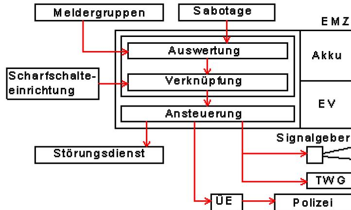
Eine Einbruchmeldeanlage überwacht automatisch Gegenstände auf Diebstahl oder Flächen und Räume auf unbefugtes Eindringen.
