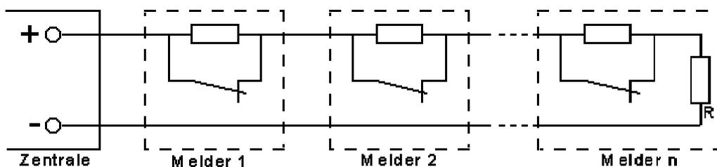
Beim Stromschwächungsprinzip wird durch die Auslösung eines Melders ein Widerstand in Reihe zum Abschlußwiderstand des letzten Melders geschaltet. Dadurch verringert sich der Strom in der Linie. Die Stromschwächung wird von der Zentrale ausgewertet. Kurzschluß und Unterbrechung der Leitung werden als Störung ausgewertet. Werden jedoch mehrere Melder gleichzeitig ausgelöst, so kommt es zu einer Störung, da der Strom durch die Linie zu klein ist zum Auswerten.
