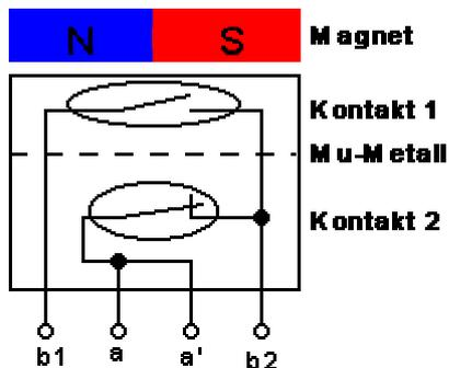
Der Schalter enthält 2 Reedkontakte, die mit einem Mu-Metall\* voneinander getrennt sind. Kontakt 1 schließt bei dem zugehörigen Magneten (entsprechend großes Magnetfeld). Entfernt man den Magneten, so öffnet sich der Kontakt.
