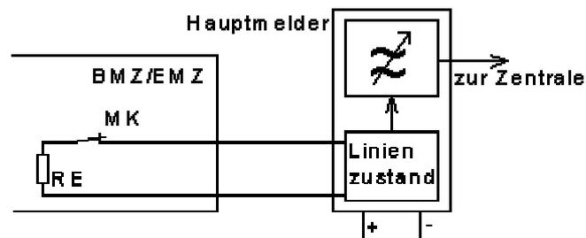
Der Hauptmelder besteht aus einem steuerbaren Tonfrequenzgenerator. Welche Frequenz dieser gerade erzeugt ist abhängig vom Zustand der Linie.
