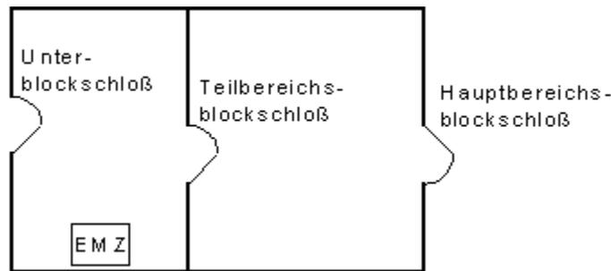
Das Blockschloß wird zusätzlich zum normalen Türschloß in die Türe eingebaut. Das Kabel wird beim Türrahmen aus der Türe herausgeführt und in einem beweglichen Kabelübergang in einem Verteiler angeschlossen. Zum Abschließen der Türe muß nach wie vor das separate Schloß verwendet werden, da sich das Blockschloß aus Sicherheit vor Fehlalarmen nur von Außen abschließen läßt.
