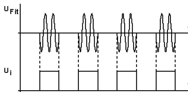
Die Auswerteeinheit der Zentrale wertet die Anzahl der Impulse aus und erkennt dadurch das jeweilige übertragene Kriterium.
