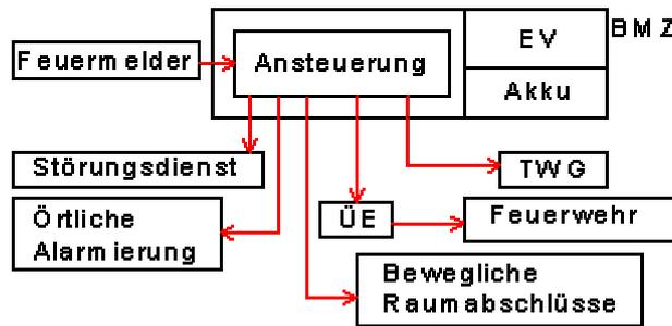
Eine Brandmeldeanlage ist eine Gefahrenmeldeanlage, die Brand und Feuer frühzeitig erkennt und meldet. Die an die Zentrale angeschlossenen Sensoren sind ständig aktiv. Es können automatische wie auch nichtautomatische Sensoren angeschlossen werden.
