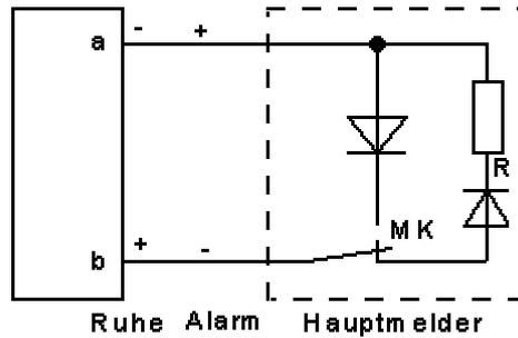
Die GLU wird hauptsächlich für den Einsatz als Übertragungseinrichtung für Gefahrenmeldungen verwendet. Im Ruhezustand fließt ein Ruhestrom von der b-Ader über den Melderkontakt und den Endwiderstand auf der a-Ader zurück.
