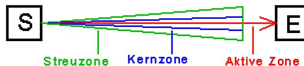
Der Durchmesser des IR-Strahls wird mit zunehmender Entfernung des Empfängers vom Sender immer größer. Er unterteilt sich in eine breite Streuzone, einer kleineren Kernzone, in der die aktive Zone ist, welche erkannt und ausgewertet wird.
