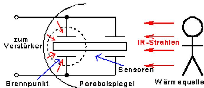
Ein IR-Melder besteht in der Regel aus einem Parabolspiegel, zwei Sensoren, wobei einer sich vom Parabolspiegel erzeugten Brennpunkt befindet. Der andere Sensor reagiert nur auf die Umgebungstemperatur.
