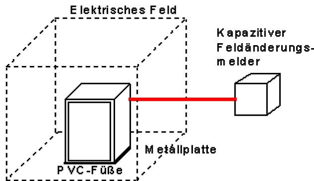
Der kapazitive Feldänderungsmelder eignet sich zur Überwachung von Einzelobjekten. Um das zu überwachende Objekt wird ein elektrisches Feld aufgebaut. Betritt eine Person dieses Feld, so ändert es sich. Daraufhin gibt der Melder ein Alarmsignal ab.
