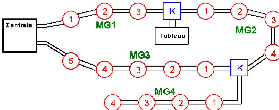
Alle Netzelemente werden in Stich und Ringanordnungen an einem zweidrähtigen Bus angeschlossen. Die Stromversorgung der Melder erfolgt über die selbe Zweidrahtleitung wie die der Datenleitung, sofern der Maximalstrom nicht überschritten wird. Über ein zweites Adernpaar wird in der Regel eine Hilfsspannung mitgeführt, falls ein Netzelement mehr Energie benötigt.
