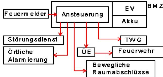
Eine Brandmeldeanlage ist eine Gefahrenmeldeanlage, die Brand und Feuer frühzeitig erkennt und meldet. Die an die Zentrale angeschlossenen Sensoren sind ständig aktiv. Es können automatische wie auch nichtautomatische Sensoren angeschlossen werden.
